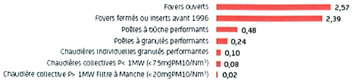
Figure 10 : Facteurs d'émissions en PM10 en gr/kwh (source ADEME)
